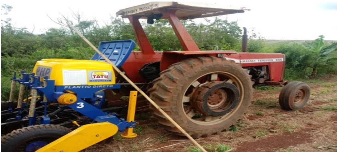
Figura 8. Trator 70 cv + semeadora de três linhas
