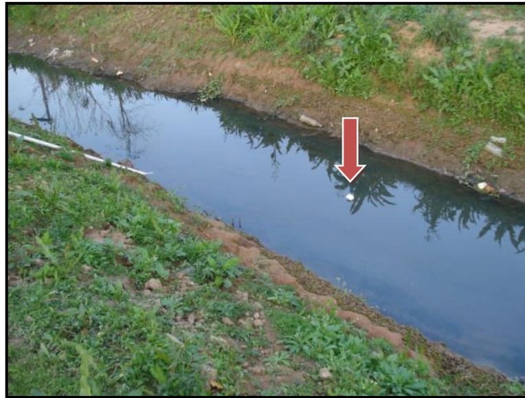
Figura 23 – Peça de isopor para registro da velocidade de escoamento do córrego
