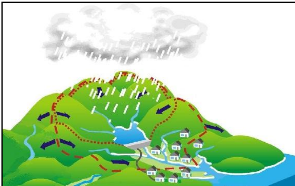
Figura 5 – Bacia hidrográfica com limite, sistema de captação e ocupação urbana em torno do rio principal
