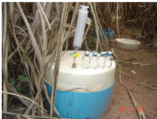
Figura 5. Câmara de coleta de gases com seringa e frascos vedados. Adaptado de Zotelli (2012).
